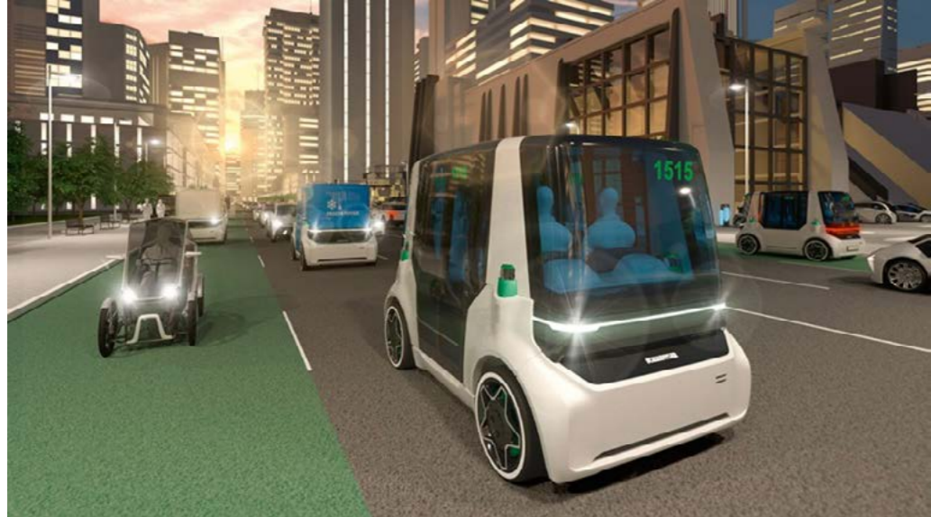
Enger Wendekreis 5M: Autonomes Robotaxi + Lieferfahrzeug Mover Schaeffler, Deutschland
