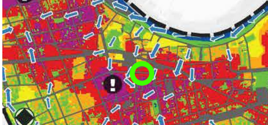
Hitzekarte von Offenbach mit eingezeichneten Windrichtungen (blaue Pfeile). Der bespielte Hugenottenplatz ist grün markiert. Heat map of Offenbach with indicated wind directions (blue arrows). The activated Hugenottenplatz is marked in green.
