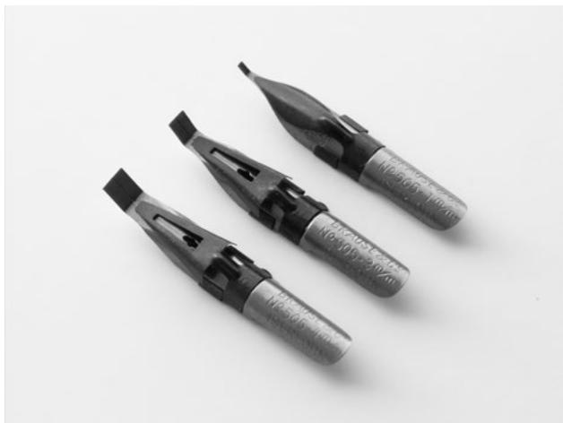
Abb. 13 Mit dem Federhersteller Brause hat Hoefer eine rechteckige Plattenfeder entwickelt, die »Brause 505«. Aufgrund ihrer Elastizität konnte er damit geschriebene Schriften zeichnen, aber auch die eckigen Abschlüsse einer Groteskschrift erzeugen.
